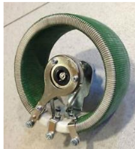
Figura 10. Potenciómetro del tipo bobinado. Fuente: (MECAFENIX, 2020)
