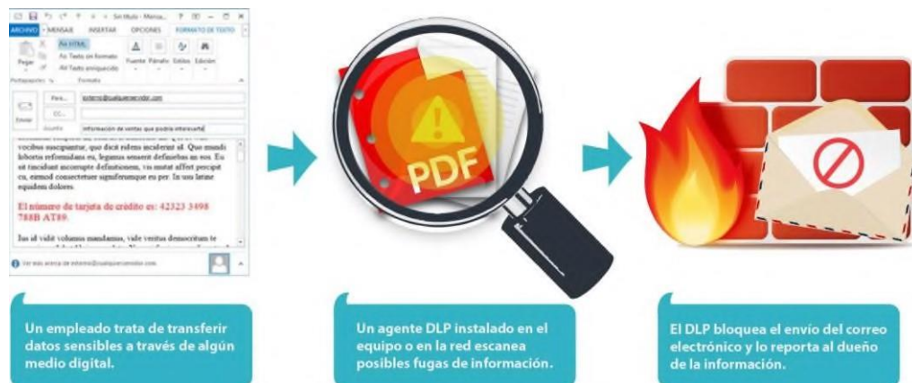
Figura. 1: Funcionamiento de un DLP tomado de: https://revista.seguridad.unam.mx/numero25/dlp-tecnolog-para-laprevenci-n-de-la-fuga-de-informaci-n
