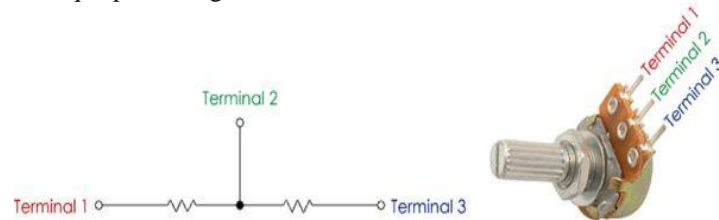
Figura 8. Potenciómetro y sus terminales Fuente: (MECAFENIX, 2020)
