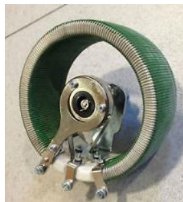
Figura 10. Potenciómetro del tipo bobinado. Fuente: (MECAFENIX, 2020)
